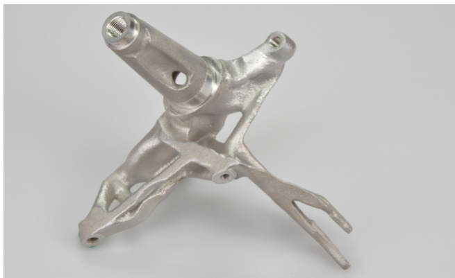
Strukturoptimierter Radträger eines Ultraleichtfahrzeugs: Design für Additive Manufacturing – Herstellung im 3D-Drucklabor Metall und Strukturwerkstoffe am Fraunhofer EMI. © Fraunhofer EMI | Bild in Farbe und Druckqualität: www.fraunhofer.de/presse .
